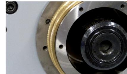
Kegel-Hohlschäfte (HSK) mit Plananlage sind nach DIN 69893-1 genormt. Die verschiedenen Formen unterscheiden sich hinsichtlich Mitnehmersparung und Anlegebund. Die Form C wurde speziell für die Verwendung bei manuellen Werkzeugwechselsystemen entwickelt.
