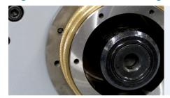
Kegel-Hohlschäfte (HSK) mit Plananlage sind nach DIN 69893-1 genormt. Die verschiedenen Formen unterscheiden sich hinsichtlich Mitnehmeraussparung und Anlagebund. Die Form C wurde speziell für die Verwendung bei manuellen Werkzeugwechselsystemen entwickelt.
