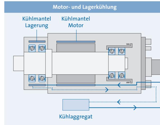
Die Reduktion der betriebsbedingten Wärmeentwicklung steigert die abnehmbare Spindel-leistung und sichert maximale Produktivität sowie hohe Bearbeitungsqualität.
