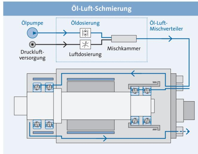
Die Öl-Luft-Schmierung gewährleistet höchste Effektivität bezüglich Verbrauch und Schmierwirkung bei maximalen Drehzahlen:
