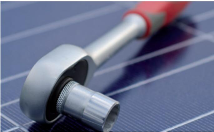
Eine Antriebsbewegung mit wiederholtem Richtungswechsel wird schrittweise in eine gleichgerichtete Drehbewegung übertragen.
