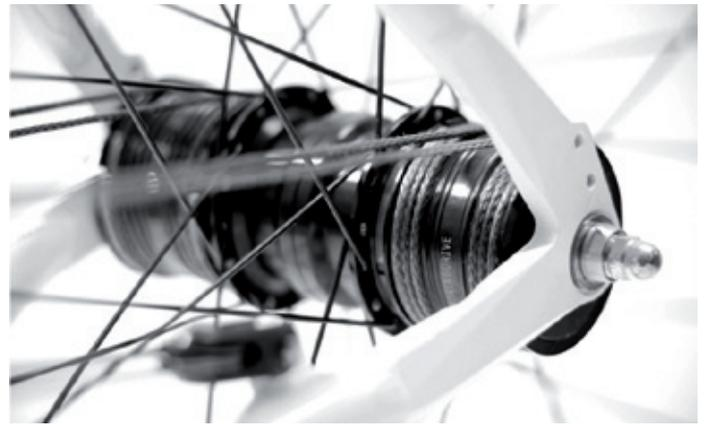
Übersteigt die Geschwindigkeit der Abtriebsseite die Drehzahl des Antriebs, entkoppelt der Freilauf (An- und Abtrieb) und wechselt vom Kraftschluss in den Leerlauf.
