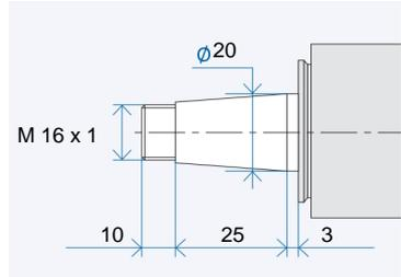
Werkzeugaufnahme: Passbohrung mit Plananlage nach GMN Standard
