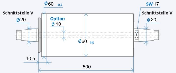
Bohrung durch die Spindelwelle ist Option
