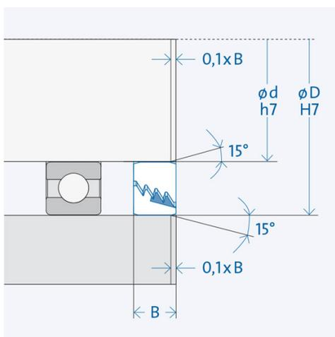
Der größere Spaltdurchmesser  $e_2$  muss zur Seite der Beaufschlagung zeigen
