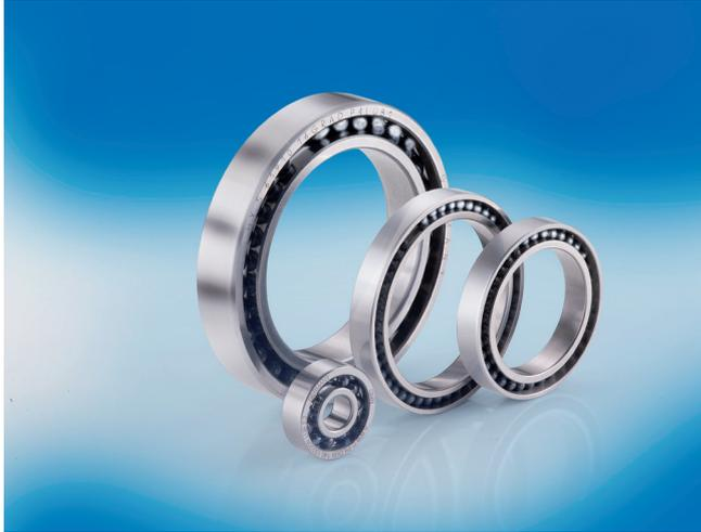
GMN verfügt über eine große Auswahl an Spindelnkugellagern (Schrägkugellager) in verschiedenen Größen (ID: 5 mm bis 120 mm), Baureihen (618., 619., 60., 62..) und Bauformen (S, SM, KH) sowie weiteren unterschiedlichen Ausführungen. Daraus und aus einer Vielzahl von Rillenkugellagern entwickelt und fertigt GMN Fanglager mit beispielsweise einem Lagerpaar oder einem Einzellager am Wellenende.
