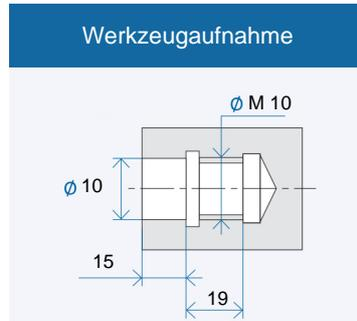
Werkzeugaufnahme: Passbohrung mit Plananlage nach GMN Standard
