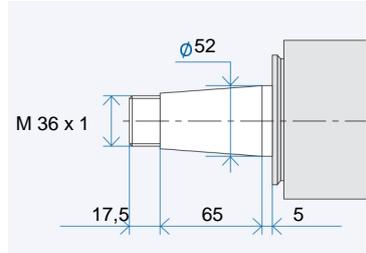
Werkzeugaufnahme: Passbohrung mit Plananlage nach GMN Standard
