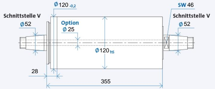
Bohrung durch die Spindelwelle ist Option
